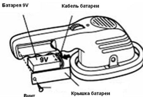
**Установка батареи:** Устанавливайте батарею только под присмотром взрослых. Ослабьте винт с маленькой крестообразной головкой с помощью отвертки и снимите крышку батареи. Присоедините стандартную 9V батарейку к кабелю батареи так, как указано и вставьте ее в специальный отсек. Закройте крышку и закрутите винт.
